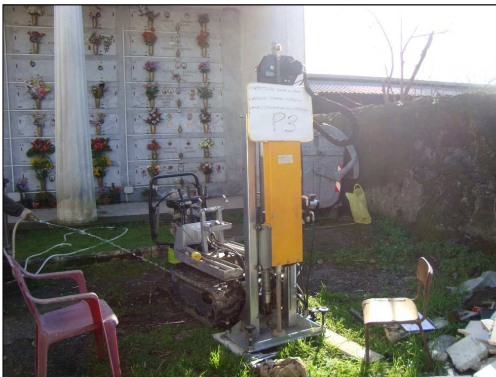
Foto 6. Postazione della prova penetrometrica DPSH P3 eseguita (anno 2012).
