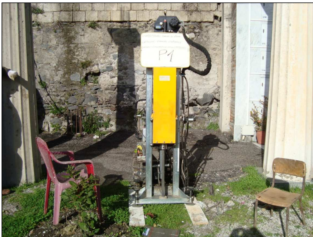
Foto 1. Postazione della prova penetrometrica DPSH P1 eseguita (anno 2012).
