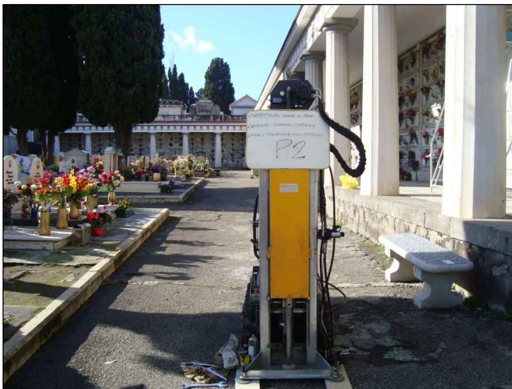
Foto 3. Postazione della prova penetrometrica DPSH P2 eseguita (anno 2012).
