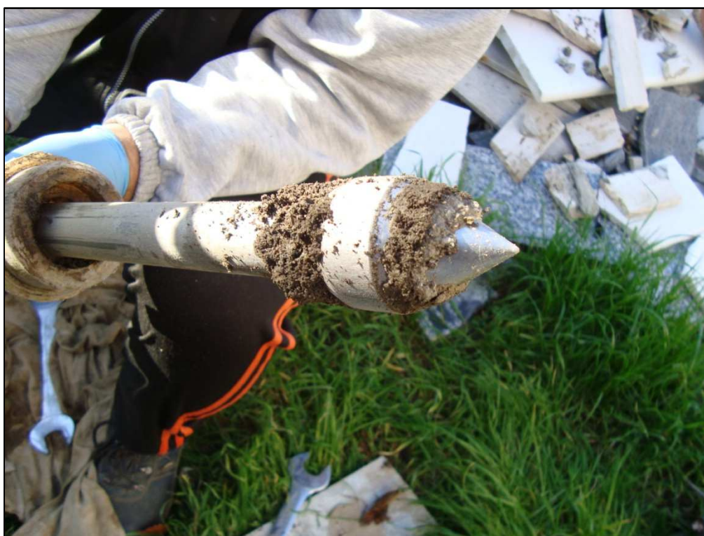
Foto 8. Punta conica alla fine dell'esecuzione della prova DPSH P3.
