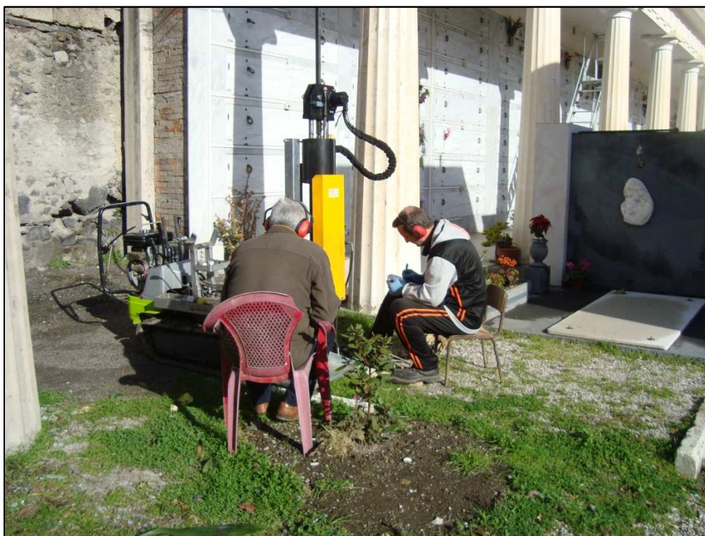
Foto 2. Esecuzione della prova DPSH P1 (anno 2012).
